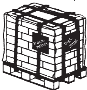
Exemple de palette entourée par un couvercle de protection et une bande de métal:
