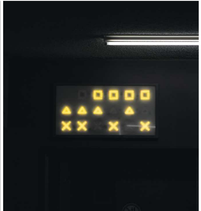
Eine binäre Uhr an der Kantonsschule Romanshorn, realisiert von zwei Gymnasiasten. Sie zeigt übrigens 15 Uhr 58 und 53 Sekunden an. KARIN HOFER / NZZ
