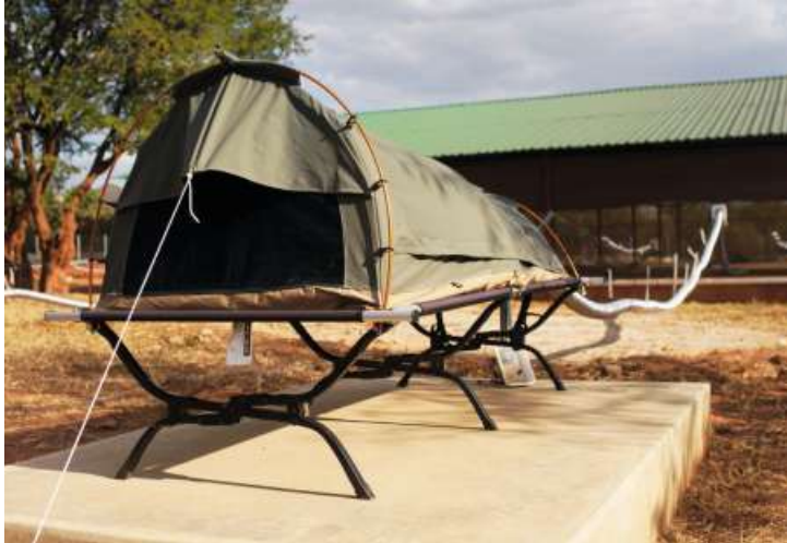
Das silberne Rohr hinter dem Zelt leitet den Körpergeruch des Schlafenden in das Haus mit den Mücken.
