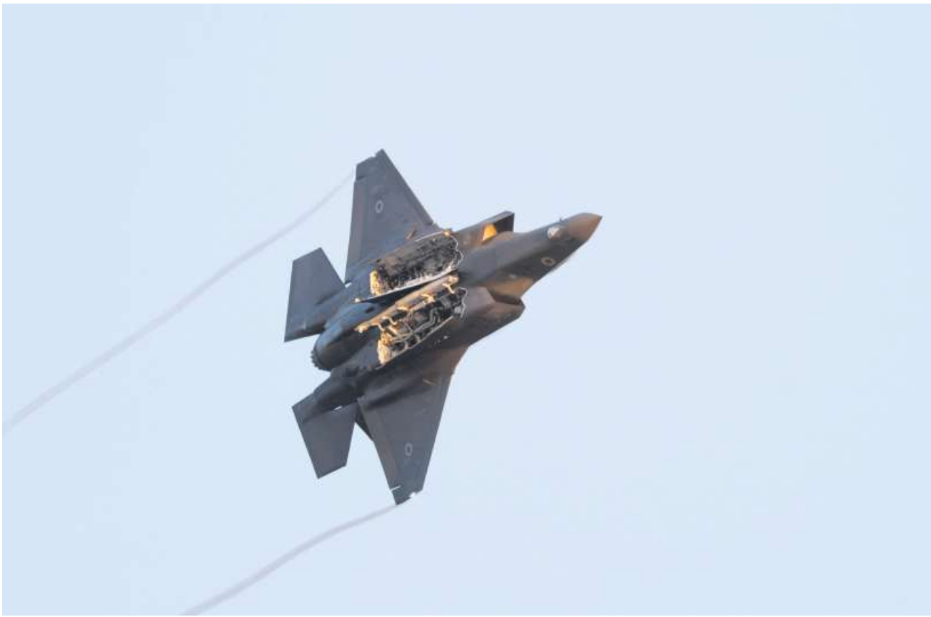
Das zentrale System in der Luft ist die israelische Version des F-35, im Bild mit offenen Lenkwaffenschächten.
