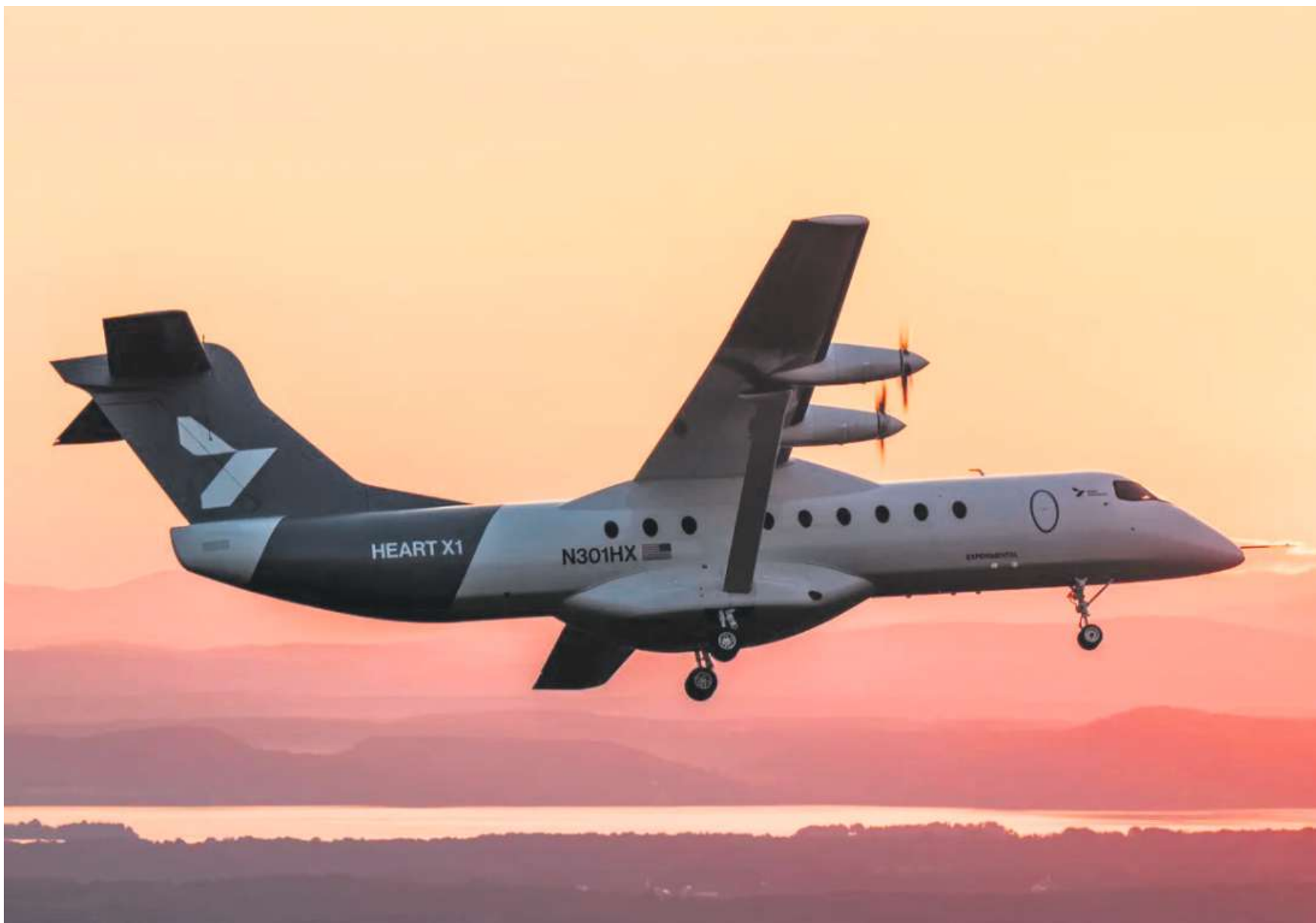
Die batterieelektrische X1 des schwedischen Herstellers Heart Aerospace ist das derzeit grösste Linienflugzeug mit Elektroantrieb.
